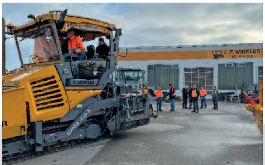
der eigentliche Asphaltsteinbau. Das Asphaltmischgut wird vorn in den Bunker des Fertigers gekippt und nach hinten zur Einbaubohle gefördert und davor verteilt. Die Einbaubohle baut das Mischgut ein, indem sie es gleichmäßig verteilt, verdichtet und eben abzieht. Den Abschluss machen die Walzen, die den entscheidenden Rest der Verdichtung des Asphaltmischgutes erledigen müssen.
