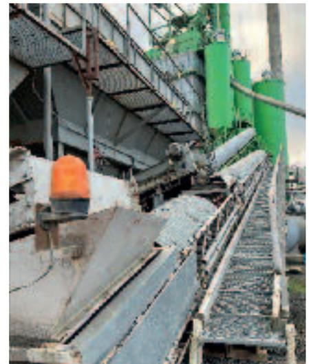
Förderband zum Transport der Zuschlagsstoffe in die Trockentrommel
