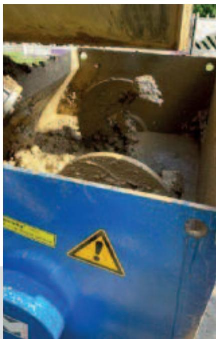
Hergestellter FB fließt aus der mobile Mischanlage direkt in den Rohrgraben
