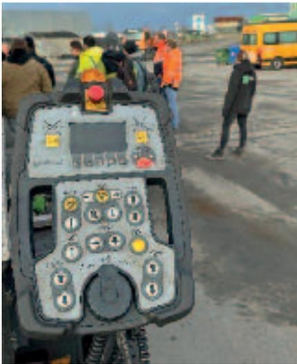
Bedieneinheit für den Bohrlängänger zur Steuerung des Asphaltteinbaus mit dem Straßenfertiger
